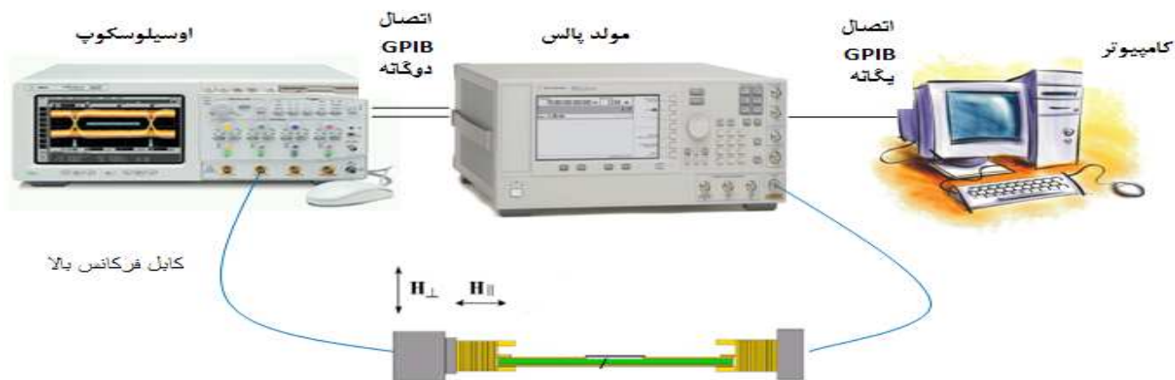
شکل ۲ طرح واره چیدمان آزمایش تشدید فرومغناطیس
